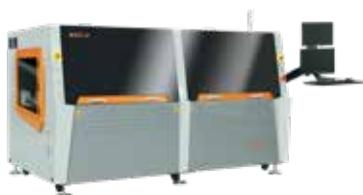
MAS-i2有三段输送,当一块板在焊接时,另一块板处于预热状态,第三块板处于涂布焊剂状态。MAS-i2可配备两个助焊剂喷射阀,两个独立的焊锡,既可实现两种助焊剂的快速换线,也可实现有铅无铅的快速切换,还可以同时双头对拼板进行焊接,实现产能加倍。MAS-i2启动和运行的典型编程时间仅为10分钟,这样的设计使其能大大节省时间并实现高生产量、高产能、高灵活性和高稳定性,这就是MAS-i2的特色。
