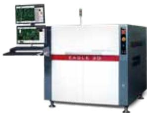
EAGLE 3D 8800 TWIN AOI在所有模式的3D测量中都使用了双面12向投影,以最大限度地减少由于阴影效应造成的误差,并在所有FOV区域同时执行100%的2D和3D检测。通过TWIN,可对每个PCB板进行顶部和底部双面同时检测。Pemtron的新型检测头是在现有的3D检测头基础上升级而来的,通过采用远心透镜,最大限度地减小了透镜曲面失真,配置双联的顶部和底部10MP高速摄像头,检测高度为27mm。采用了先进的高速检测和测量技术以及2D和3D同步检测算法,速度可达58.3 cm<sup>2</sup>/s。
