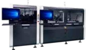
ASR (Automatic Solder Repair) 是神州视觉全球首创的一款产品, 该产品由全自动视觉检测及自动焊接两个模块组成, 可快速准确检测出PCB短路、少锡、虚焊、锡洞等缺陷, 并对PCB缺陷自动定位, 快速分类, 快速维修, 完全不需人工干预, 真正做到解放双眼解放双手。ASR配备异步双头独立工作的双头模式, 产品长度≤300mm可提升一倍的效率, 采用自主研发的国际专利磁电泵技术, 电磁结构与缸体非接触设计, 静音且焊接稳定, 并且缸体内部结构简单方便维护, 同时还搭载自动标识、二层波喷嘴、可视化编程、视觉定位、自动加锡、喷嘴自动清洁、飞行拍摄等多项创新技术。
