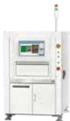
3D SPI平台建立在一个增强的机械平台上,以保证检测过程中的稳定性、准确性和精度。它配备了改进的运动控制器(EtherCAT),用于即时通信。智能SPI解决方案简化了生产线与您选择的MES之间的数据交换,从而为互联工厂实现数据可追溯性。此项3D SPI可采180 cm<sup>2</sup>/s的高速检测。此项创新的3D SPI通过高速10 μm 4MP顶部相机和两个用于3D分析的莫尔投影仪,不仅可以检测焊料,还可以检测凸点、助焊剂、胶水、裸板和整体电路板表面。
