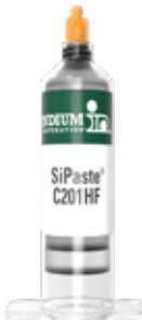
SiPaste®C201HF采用卓越的氧化屏障配方技术, 具有和行业领先的防止不润湿开路(NWO)缺陷的性能。SiPaste®C201HF的残留物是良性、可清洗的, 可用市场上常见的水基、半水基清洗剂去除, 也适用于免洗应用。
