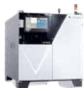
子制造业提供了无限的可能与最大限度的质量保证。3DX光技术以CT为基础,围绕THT、BGA、CSP、QFP、SSOP和芯片的贴片及焊点检测提供清晰的断层图像。全自动X光系统专为超长PCB检测而设计,可对长度达1600毫米、15公斤重的印刷电路板进行全面的在线检测。这为LED、半导体、IT和通讯电子设备提供了一条无误差的、稳定的工艺线。与Viscom的其他检测系统一样,iX7059系列产品附带一套全面的工具包,用于统计过程控制和高级过程优化中的机器间通信,完全满足了日益增长的各种质量保障的需求。
