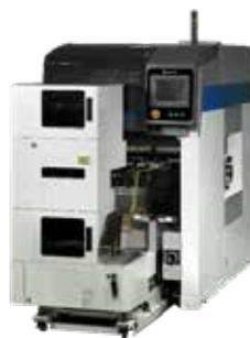
SmartFAB是由富士机械研发的，应对SMT贴装工序无法处理的工艺以及实现自动化的电子组装机。通过XYZ机械手上并列配置2个工作头，与供应装置、搬运装置组合，可以进行最高高度为75mm的产品组装。通过Carry工作头处理从小型元件到大型元件，Process工作头则进行加工作业、液体涂敷、拧螺丝、涂敷锡膏等。
