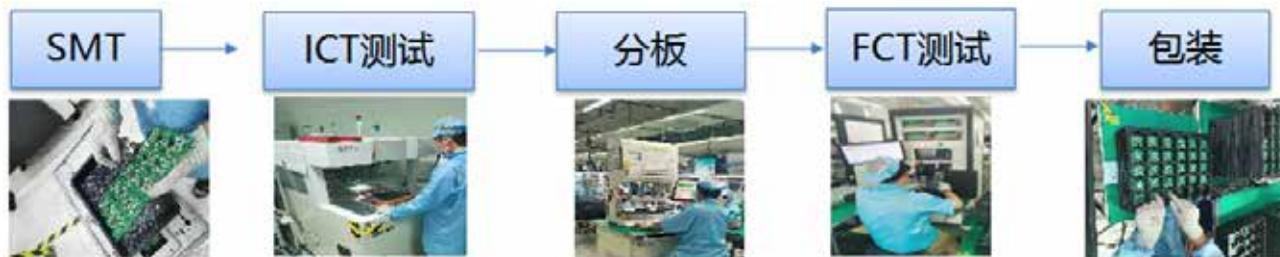
图1 目前产品的生产工艺流程
