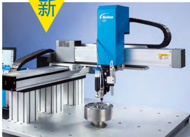
GV系列配合xQR41胶阀在航空齿轮组件上点涂油脂。
