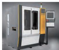
PCB 全自动高速插针机是瀚川自主研发的最新产品，主要适用于PCB板插针组装应用。产品采用柔性化设计，可兼容最大尺寸400mm\*350mm的PCB板，超高速的凸轮插针模块设计，插针速度最高可达10次/秒，多个超高速凸轮插针模块有机结合，可实现最多6种端子同时插针。同时产品采用了工业物联网技术，可实现产品生产过程中全程数据追溯。产品严格按照国际化生产标准设计，质量可靠，全自动运行，生产效率极高，可有效降低客户生产运营成本。
