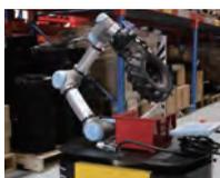
智能调度：结合移动小车搭载自动构建地图导航特性，UR 机器人可以实现大范围空间内的物料抓取和移动小车物流传递。
