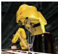
透过 FANUC iRvision 2D 视觉系统，对金属手机壳外观进行瑕疵检测。避免人力由于疲劳的漏检，在高强度的重复视觉检测动作中，保证产品外观一致性。
