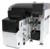
伴随着各种各样电子设备的小型化·高功能化，在贴装形态中对高密度化和复杂化的要求比现在更高，特别是对于 SMD 和半导体的混载贴装的要求正在日益增加。为了促进降低生产成本和缩短交货时间，研发了将半导体的后道工序组合进贴装工序的 NXT-H。
