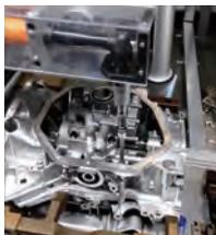
安全可靠：UR 机器人可以协同作业员，在共同空间安全可靠的完成拧螺丝工作，不需要安全围栏。
