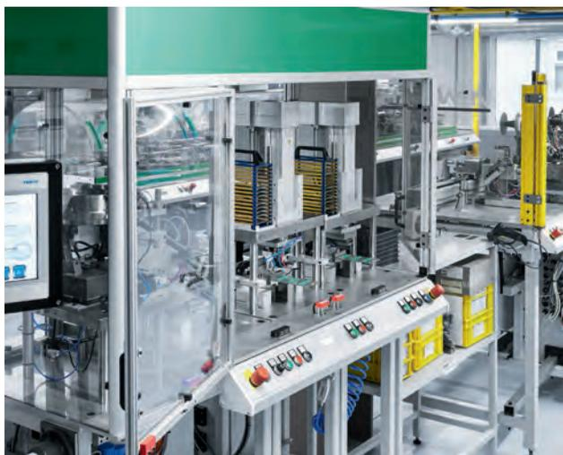
图3：保证高精准性灵活性及可靠性的插针生产线
