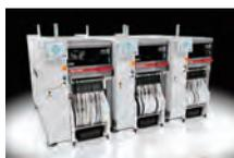
极速的速度与品质铸就高速生产。凭借高达 78,000cph 的速度，全新 SIPLACE TX 树立了实际贴装性能的新标杆。得益于更快的贴装速度，和仅为 100 厘米宽的极为紧凑的设计，SIPLACE TX 可以在仅仅 4.5 平方米的空间实现高达 156,000cph 的性能，这标志着占地面积效率的巨大飞跃。
