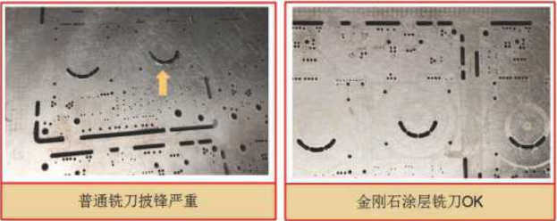
图4：普通铣刀和涂层铣刀铣外形效果对比
