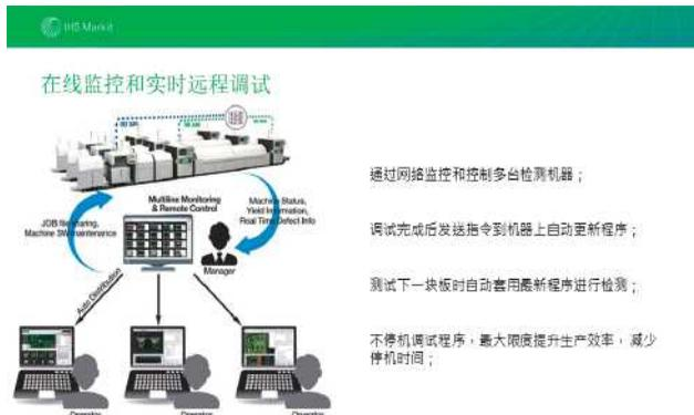
在线状态监控，主要通过传感器在线远程监控设备的运行情况，当监测到设备工作状态不好的时候就报警，但这样的方式也是事后补救维修。而预测性维护可以通过大数据积累设备运行情况预判将要发生失效的时间，这样工厂就可以防患于未然，提前派出工程师去处理，减少工厂停机时间，减少损失。
