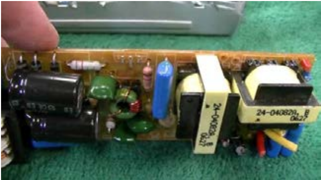
图13：顶部照明的镇流器组装
