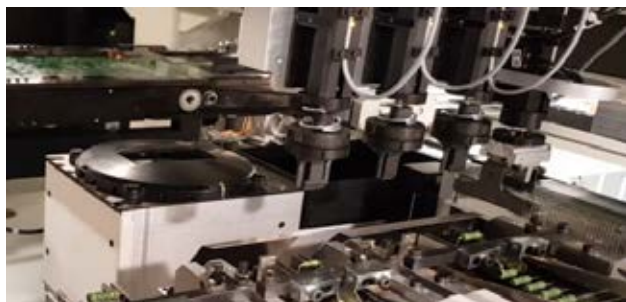
图7: Uflex配置四个功能头，卧式元件的预成型和LCD显示器的整形夹取
