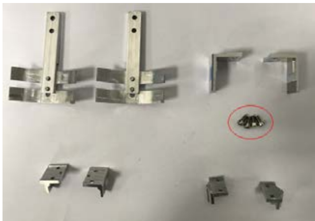
图5: 针对各式各样插装元件，设计与之匹配的夹爪，更换每副夹爪仅需拆卸四颗螺丝。
