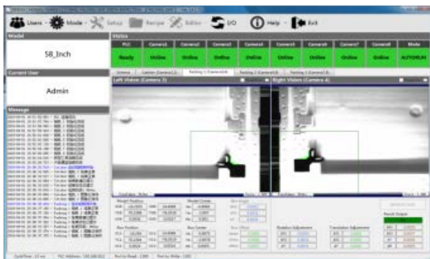
图3 包装箱检测界面，相机拍照后，根据检测的角度和平移偏差计算XXY平台的旋转量和平移量，一次性传送给PLC，由PLC控制XXY平台动作。
