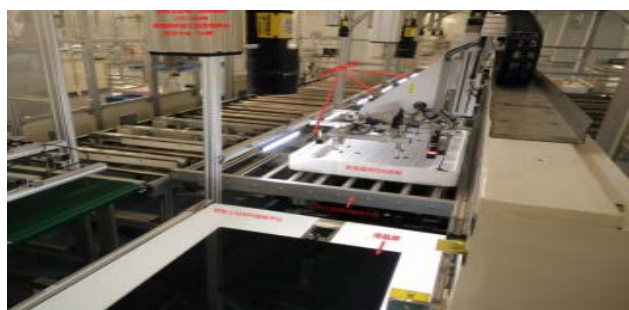
图1 打包工位现场照片，这是Packing工位现场照片，液晶屏由前面的传送带输送到XXY平台上进行检测，XXY平台根据视觉检测数据对液晶屏进行角度和平移调整，以便机械手能够正确抓取。
